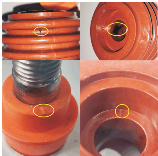
图 12 套管击穿点展示 Fig. 12 Breakdown point display of bushing
